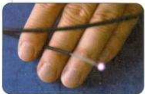
Bild 3: Polymerfaserkabel, leuchtendes Ende bei Betrieb
