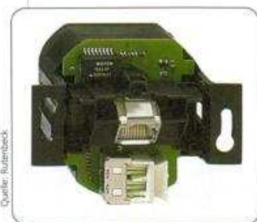
Bild 7: POFNETZ-4-Port-Ethernet-Switch mit RP4 zwei RJ-45- und zwei POF-Anschlussklemmen für den Einbau in UP-Schalterdosen. Auf der Platine befinden sich zwei POF-Klemmen für den Anschluss von POF-Duplexkabeln
